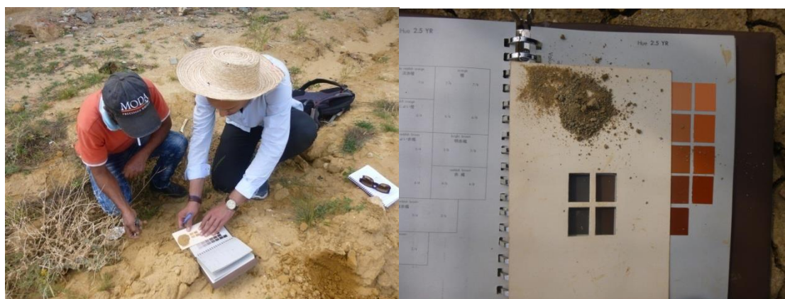
Figure 15. Démonstration et vérification du type du sol avec un agriculteur en se basant sur le code Munsell sur la zone 1
